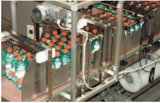
Alimentazione veloce con smistatore su più file, fino a 15 pacchi/minuto.
